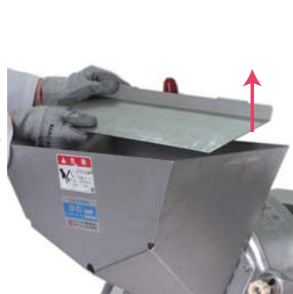
③滑り板を取り外す。
