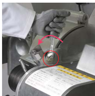
⑤調整ブロックのボルトを緩める。
