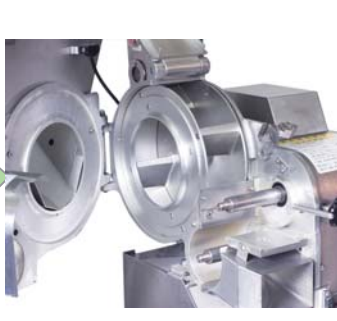
⑬スクレーパーのボルトを外してスクレーパーを取り外す。
