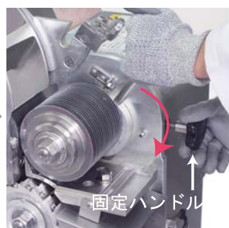
⑧固定ハンドルを緩めて操作レバーを手前に倒す。
