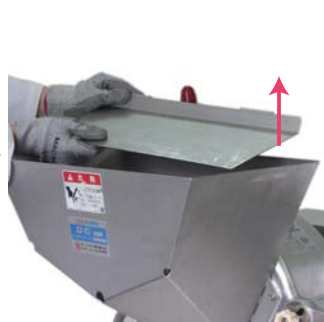
③滑り板を取り外す。
