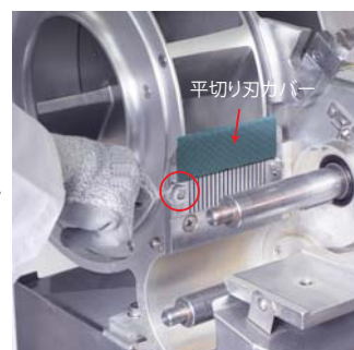
⑬スクレーパーのボルトを外してスクレーパーを取り外す。
