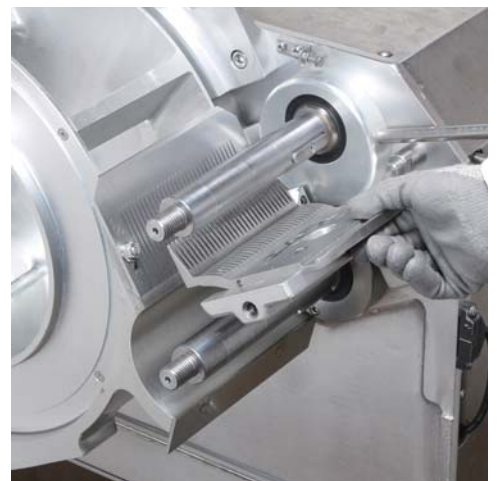
⑫スクレーパーのボルトを外してスクレーパーを取り外す
