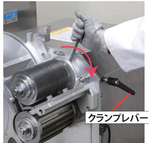
⑧クランプレバーを緩めて操作レバーを手前に倒す
