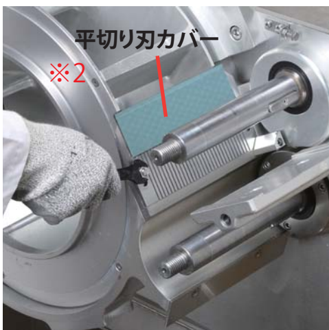
⑬平切り刃カバーを取付てから平切り刃のナットを外し平切り刃を取り外す
