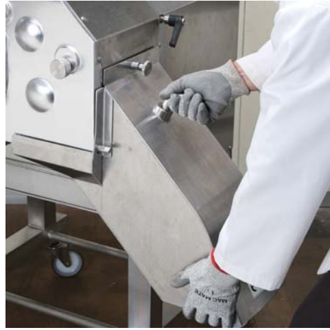
②シュートを取り外す
