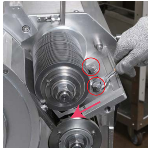
⑦スクレーパーのボルトを少し緩めて奥へスライドさせる
