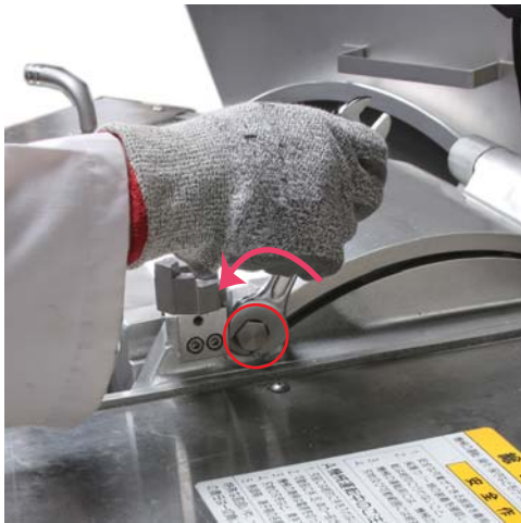
⑤固定ボルトを緩める
