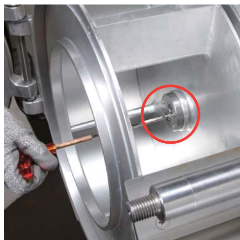
⑭インペラーを固定している2本の取り付けねじをゆるめます
