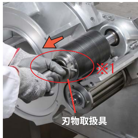
⑪刃物取扱い具で丸刃・横切刃を外す
